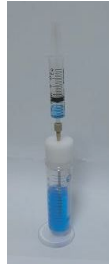
ノズルインサートを介してルアーノズルでの遠心溶液の回収
